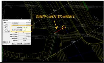
追加距離、路線中心までの距離が計算され、 路線中心までの垂線(赤)が表示される
